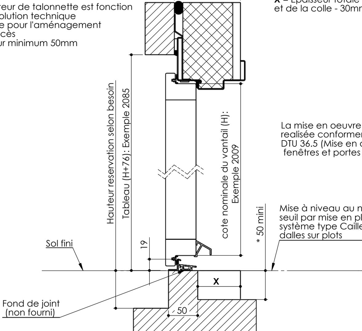
La mise en oeuvre doit être réalisée conformément au DTU 36.5 (Mise en oeuvre des fenêtres et portes extérieures).
