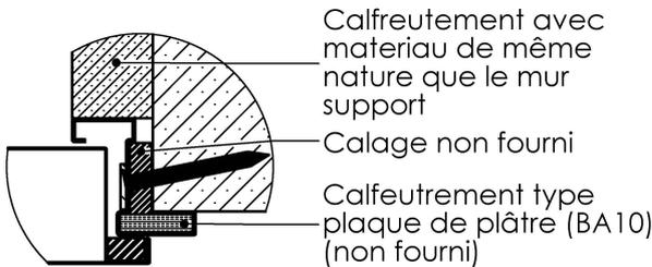
2x4 chevilles mécaniques à expansion diamètre 8mm par montant et 2x3 en traverse (Non fournies)
