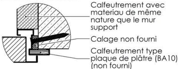
1 vantail : 3 chevilles mécaniques à expansion diamètre 8mm par montant 1 en traverse
