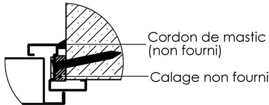
2x4 chevilles mécaniques à expansion diamètre 8mm par montant et 2x3 en traverse (Non fournies)
