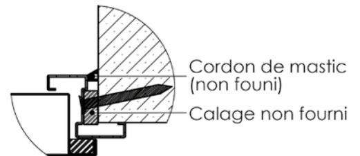
2x4 chevilles mécaniques à expansion diamètre 8mm par montant et 2x3 en traverse (Non fournies)
