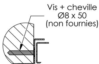
*Dans le cas d'une pose vissée, ajouter 5mm en hauteur et 10mm en largeur sur les réservations tableau pour permettre un jeu de pose*
