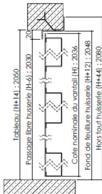
*Dans le cas d'une pose vissée, ajouter 5mm en hauteur et 10mm en largeur sur les réservations tableau pour permettre un jeu de pose*
