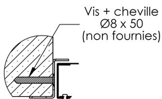
*Dans le cas d'une pose vissée, ajouter 5mm en hauteur et 10mm en largeur sur les réservations tableau pour permettre un jeu de pose*
